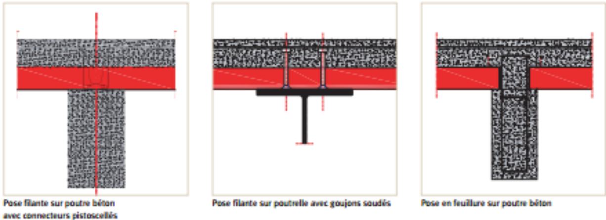
Figure06 : la pose des planchers. Source : Le Guide des systèmes planchers Arval.
