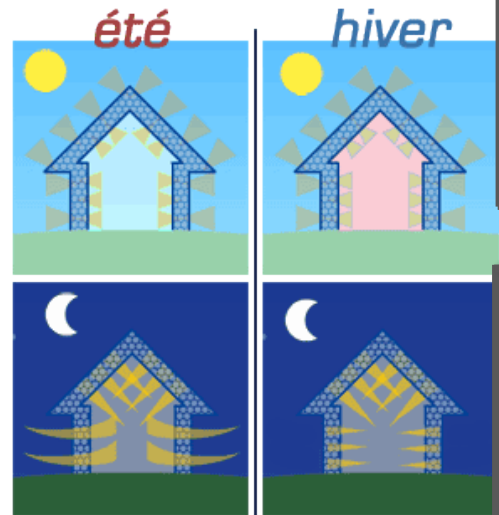
Figure V.10 : l'inertie thermique. Source : www.econology.fr
