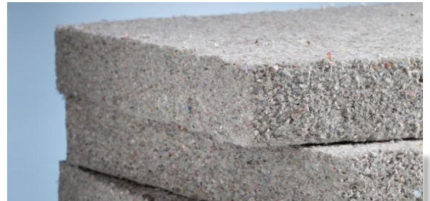
Figure13 : l'ouate de cellulose. Source : www.planete-isolation.com
