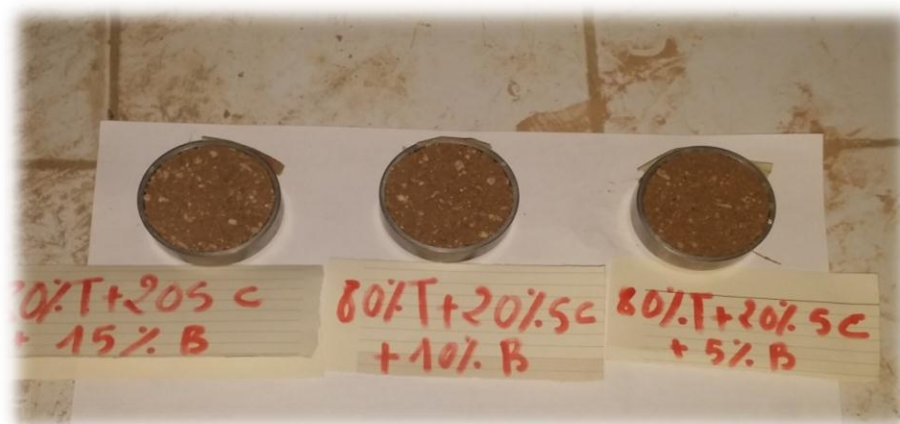
Photo III 6 : échantillons pour la mesure de gonflement libre de mélange (M1, M1, M3)
