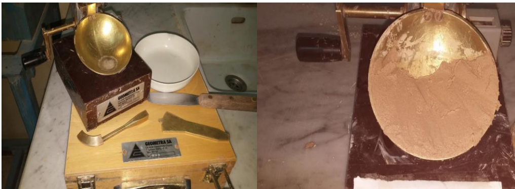
Photo II.1 : boîte de casagrande (limite de liquidité)
