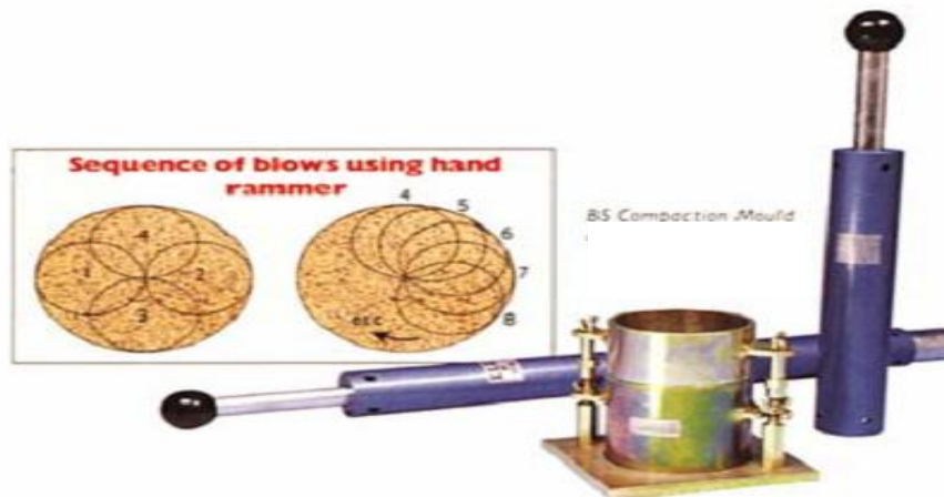
Photo II.3 : moule Proctor normal avec la dame
