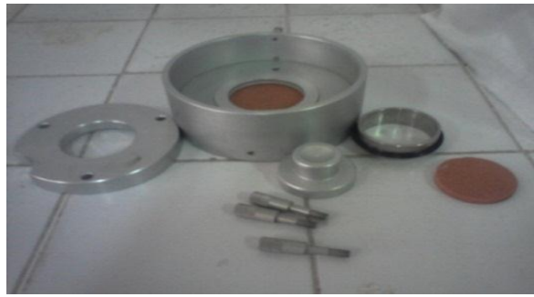
Photo II.9: La cellule œdométrique
