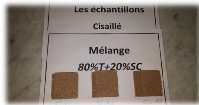
Photo 1 : Echantillon après cisaillement
