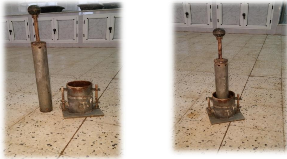
Photo II.4 : Moule Proctor normal avec la dame dans Laboratoire de Génie Civil (Laghouat).
