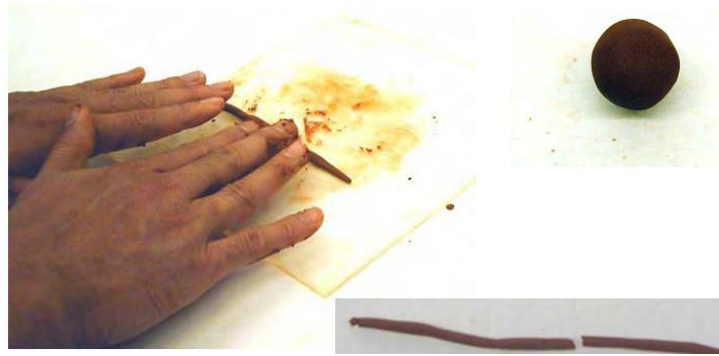
Photo II.2 : Essai de limite de plasticité.
