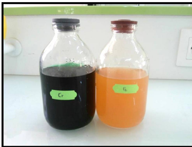
Fig. II.7 Échantillons de 200 ml des électrolytes de chrome et de fer.
