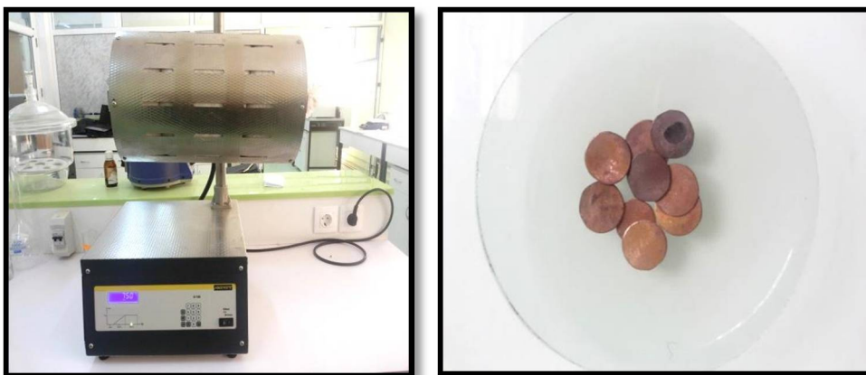
Fig. II.2 a) Four tubulaire, b) Pastilles de cuivre récupérées après traitement thermique.
