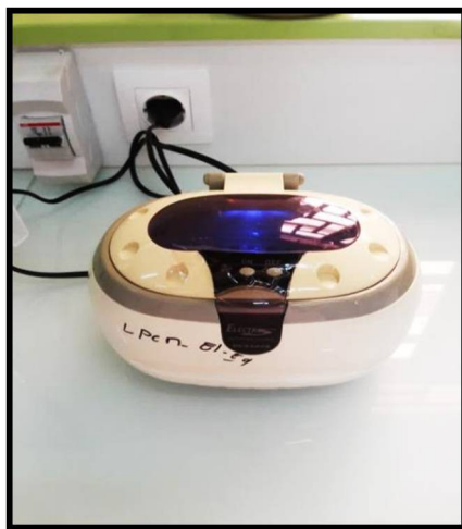
Fig. II.6 Nettoyage par ultrasons UC220CB.
