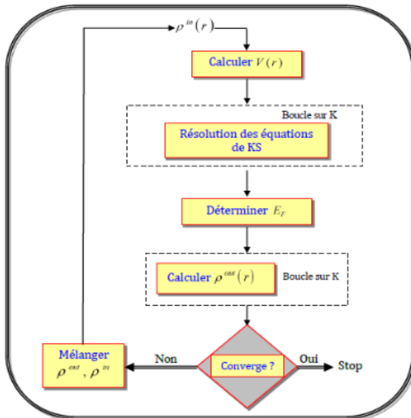
Figure(I.1) : Schéma décrivant le processus itératif de résolution des équations de Kohn-Sham
