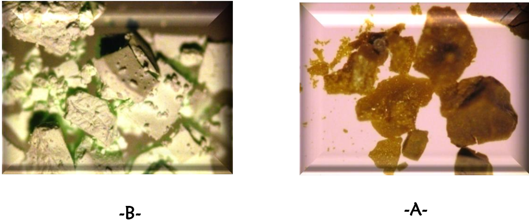
Figure II.19 : Photographies sur microscope électronique (x50) de la poudre de \text{NiWO}_4
