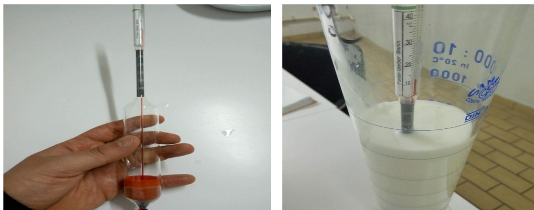
Figure 07 : Photo représentant la mesure de la densité des échantillons du lait de chamelle cru.
