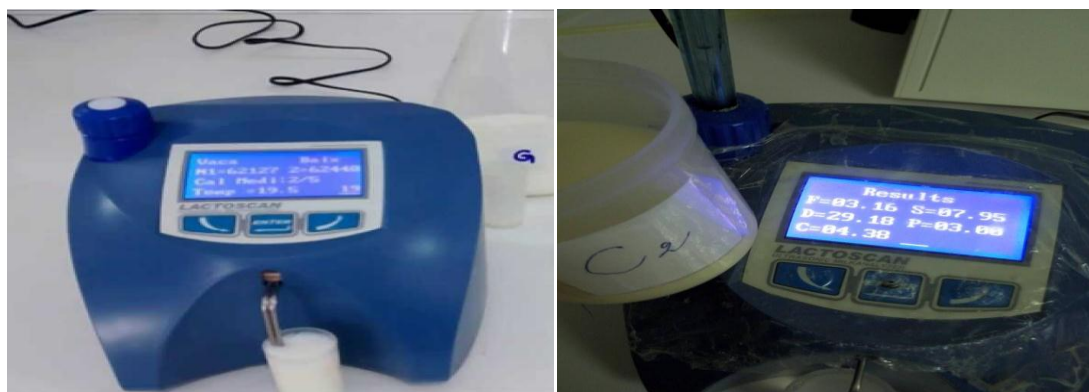
Figure 09 : Photo représentant de la mesure du taux de protéine et du lactose à l'aide d'un Lactoscan.
