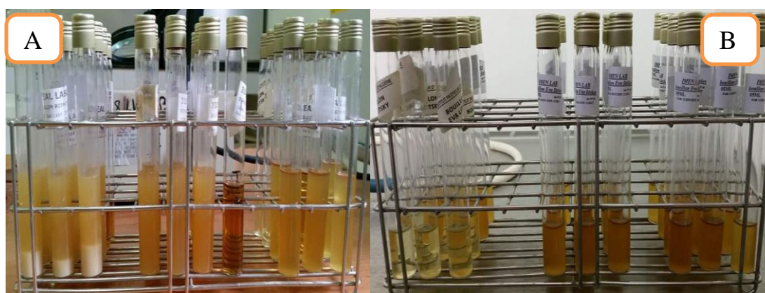
Figure 18 : Photo représentant le résultat de la recherche des Streptocoques fécaux, A : Test présomptif, B : Test Confirmatif.
