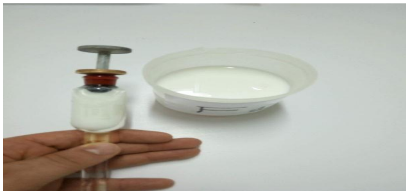
Figure 08 : Photo représentative du dosage de la matière grasse d'un échantillon de lait de chamelle par la méthode Gerber.
