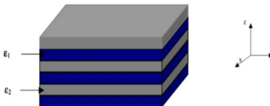
Figure I-4: BIP unidimensionnel, empilement de couches de permittivités différentes.
