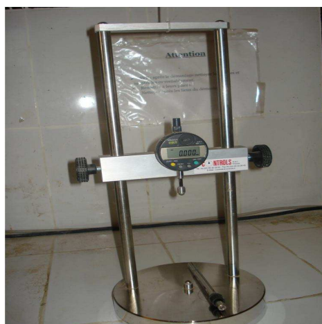
Figure II-8: Appareillage pour la mesure du retrait
