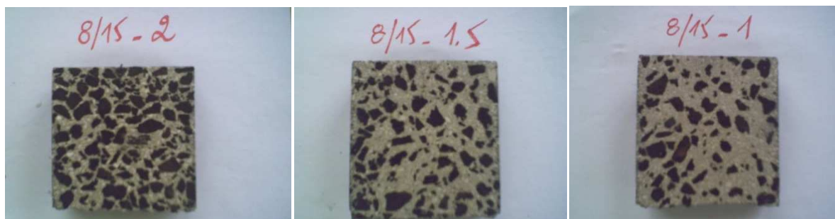
Figure III-34: Photos de coupes d'échantillons de BL 8/15
