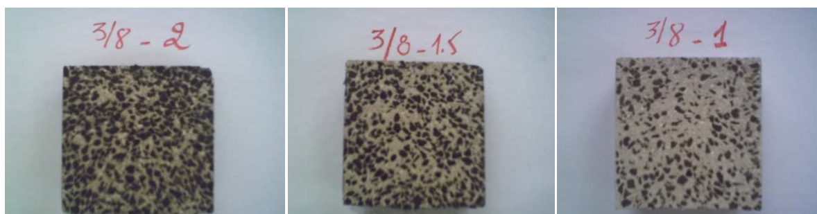
Figure III-35: Photos de coupes d'échantillons de BL 3/8
