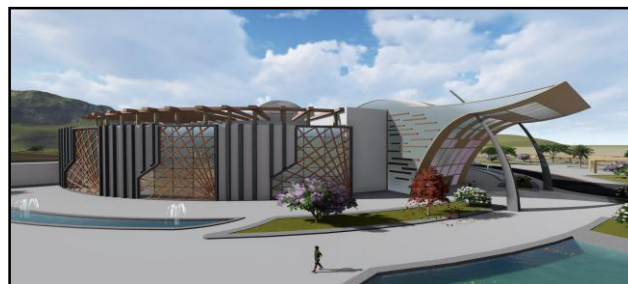
Figure 19 : La protection par les brises soleil verticaux. Source : Auteur.
