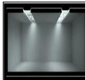
Figure 13 : Conduit de lumière Les tabatières (Skylights) Source : [www.squ1.com]
