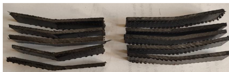
Figure II.26 : "Eprouvette de flexion après l'essai"
