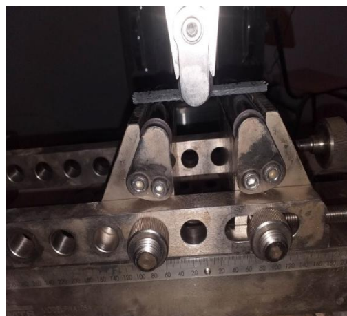
Figure II.21 : "Réglage de la portée L "
