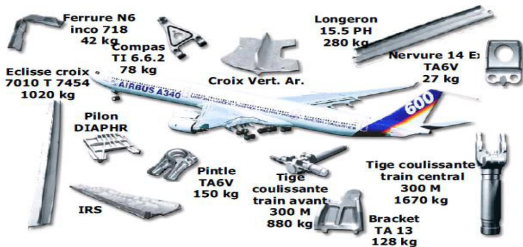
Figure (I-3): Certaines utilisations de superalliages dans l'avion [3].
