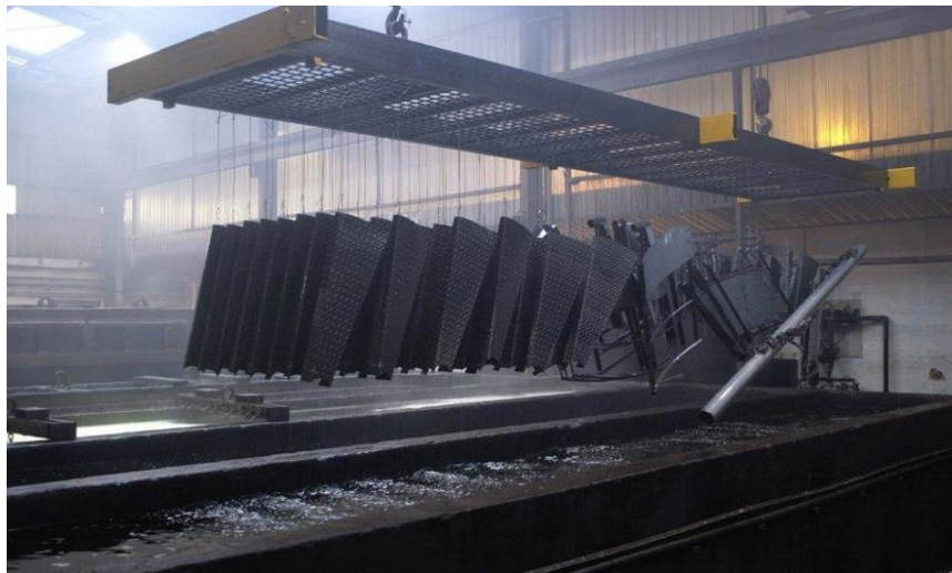
Figure (II-4) : Immersion en bain fondu métaux fondus [8]
