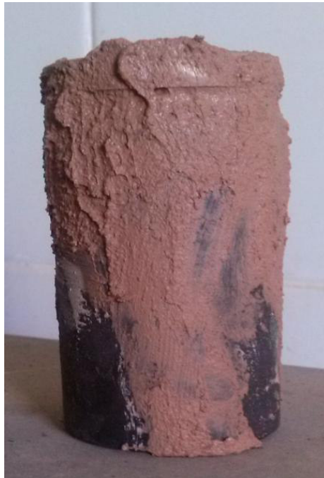
Figure III-5 : Creuset célad'argile préparé pour introduction dans le four
