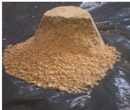
Photo (II.3) : Essai d'absorption du sable.
