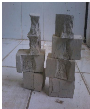
Photo (II.16) : Formes des éprouvettes écrasées
