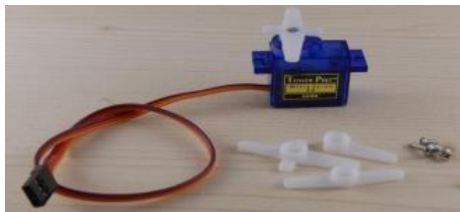
Fig. IV.12 : Servomoteur chinois "9 grammes
