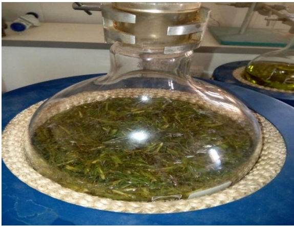
L'extraction d'HE de l' Artemisia campestris par l'hydrodistillation
