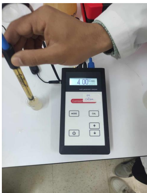
Figure N° 21 : Représentation de la mesure du pH eau (Cliché Original)
