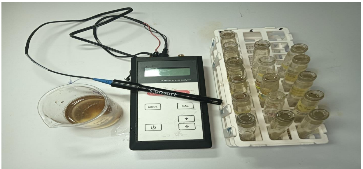
Figure 8 : Détermination de la conductivité électrique des dilutions de la farine de la caroube par un conductimètre électrique (Photographie originale).
