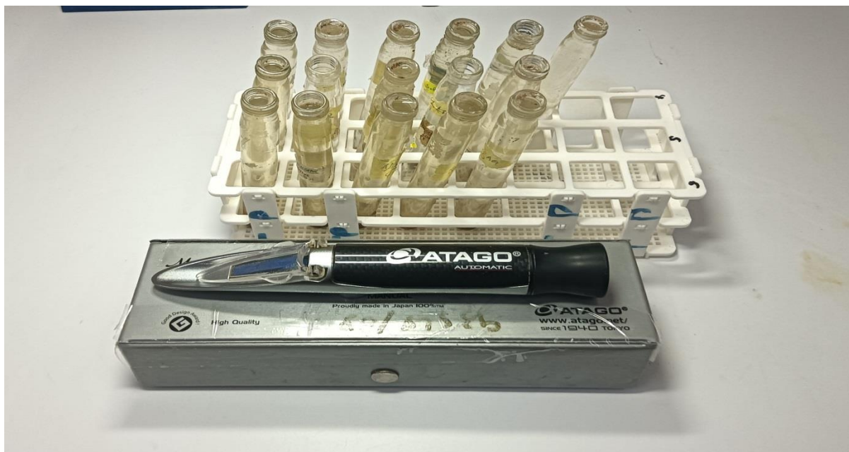
Figure 9: Préparation et dilution de la farine de la caroube et mesure de la teneur en sucres solubles totaux (Photographie originale).
