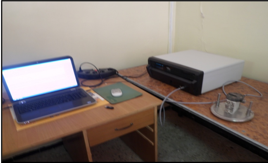
Figure III. 25: Dispositif de l'analyseur thermique Hot Disk TPS
