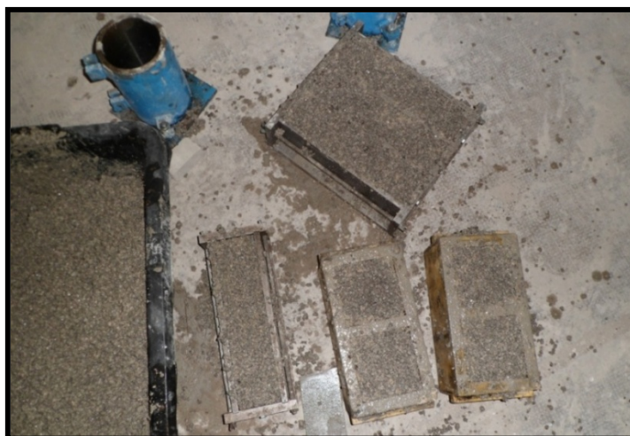
Figure III.17: Confection des éprouvettes de béton de liège
