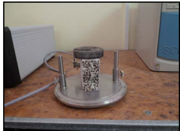
Figure III.27: Photo de sonde TPS entre deux échantillons
