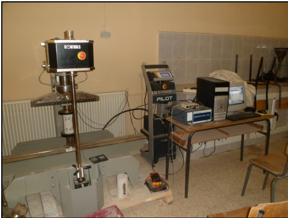
Figure III.24: Dispositif de mesure du module d'élasticité
