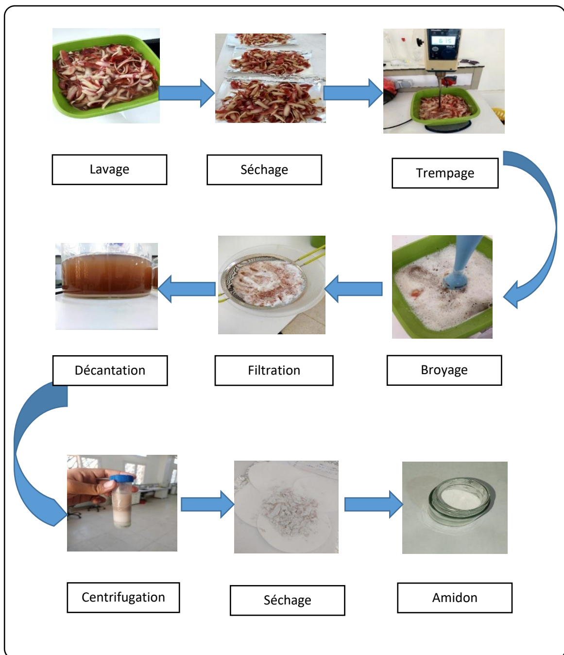
Figure II.1: Regroupe les étapes réalisées au cours de l'extraction de l'amidon à partir des épluchures de pomme de terre.
