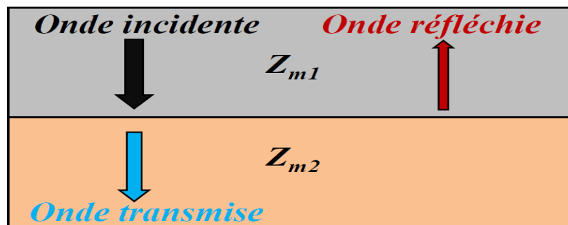
Figure 1-23 : Réflexion d'une onde acoustique sur une interface entre deux matériaux d'impédances acoustiques différentes [5].
