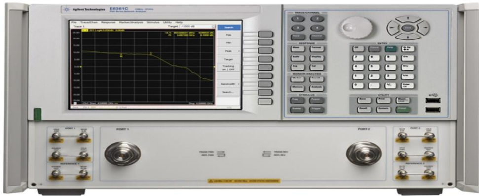
Figure 1-11 : Analyseur de réseau : Agilent E8361C, 10MHz a 67GHz .
