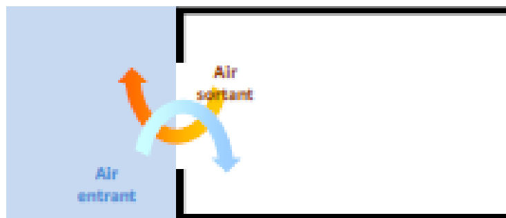
FigureVI. 4 : Schématisation de la ventilation mono façade (a)
