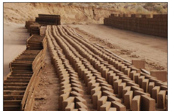
Fig I.42 : le chantier de fabrication des briques d'adobe, (source : www.cap-a.fr/construction-terre-crue-nouveau-mexique )
