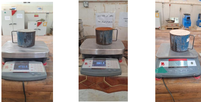
Figure II.33 : Essai de la masse volumique apparente.
