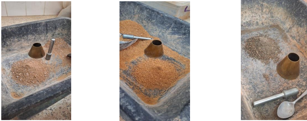
Figure II.35 : Essai de l'absorption du sable.
