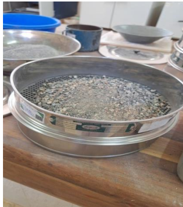
Figure II.28 : Tamisage de déchets de béton.
