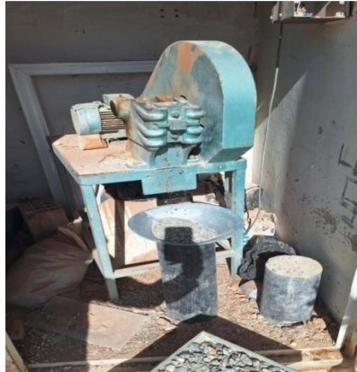
Figure II.27 : Broyage de déchets de béton.
