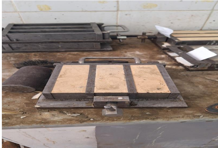
Figure II.38 : Démoulage des moules.
