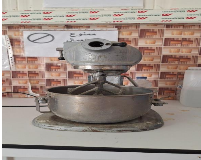
Figure II.36 : Le malaxeur à mortier.
