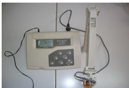
Fig03 : Mesure de conductivité électrique (CE).
