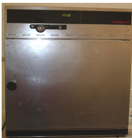
Fig01 : Détermination de l'humidité par étuve à 105°C.
