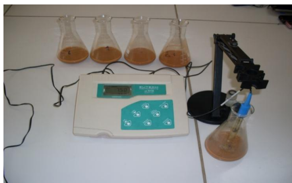
Fig02 : Mesure de pH_{eau} par pH-mètre.
