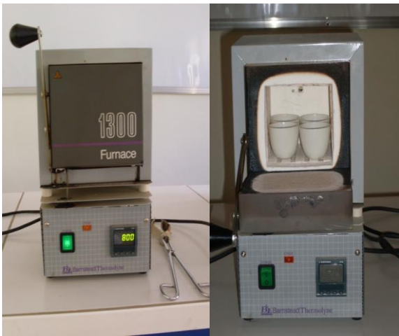
Figure04: Détermination de la teneur en matière organique par calcination.
