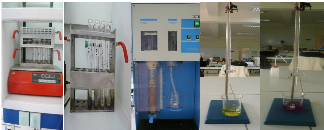
Figure 05. La détermination de la matière azotée par le dosage de l'azote totale, selon méthode de Kjeldhal.
