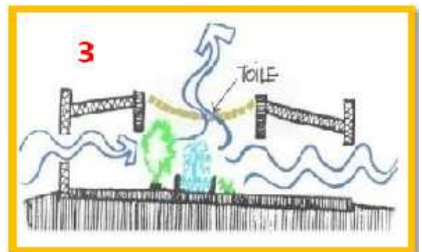
Figure III. 7 : Schéma représente le rafraîchissement par évaporation. Source : Guide ICEB-ARENE
