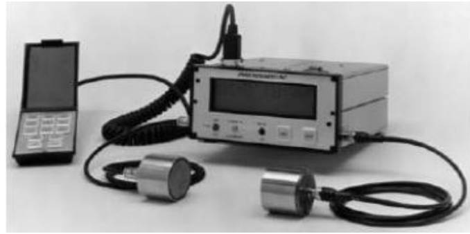
Fig I5 Appareil de mesure de la vitesse d'impulsion.
