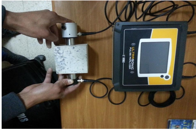
Fig. II.6 Mesure du temps de transit par l'ultrason.
