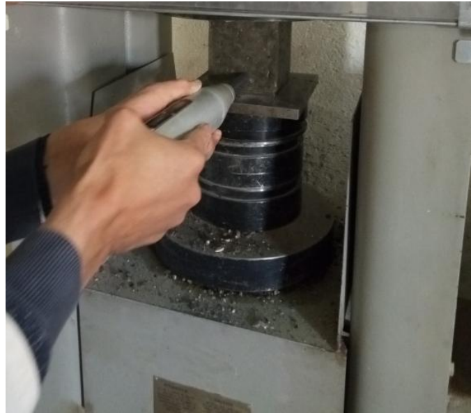
Fig II.8 Mesure de l'indice de rebondissement par le scléromètre.
