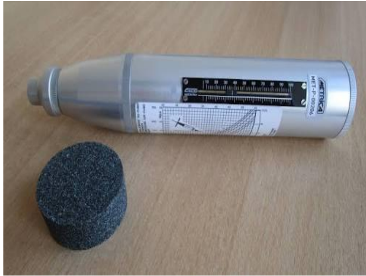
Fig II.7 Le scléromètre est de type N et de modèle C 181.
