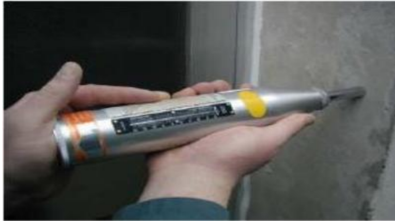
Fig. I.1 Marteau de rebondissement de Schmidt type N en cours d'utilisation.
