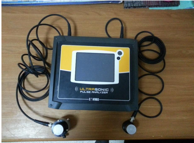
Fig II.5 Appareil de l'ultrason utilisé.
