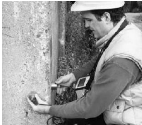
Fig 1.8 Application de la méthode de la vitesse d'impulsion sur béton in situ.
