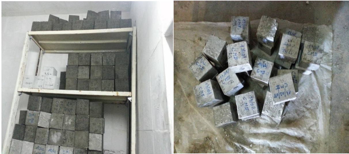
Fig II.4 Éprouvettes conservées dans la Chambre humide à laboratoire
