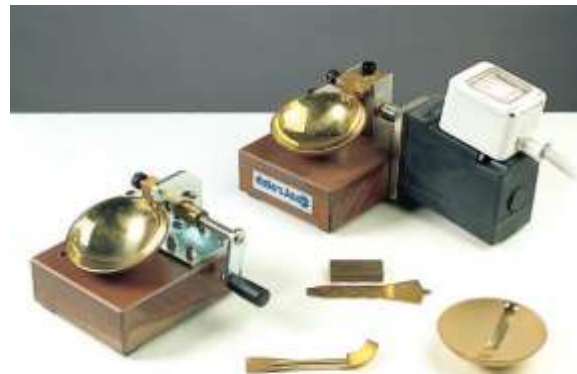
Figure II.5 : La coupelle de CASAGRANDE
