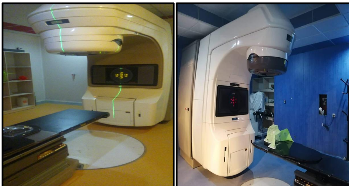
Figure (IV.2) : Les accélérateurs linéaires à gauche clinac C600 et à droite Clinac DHX 2300 [Centre Anti Cancer CHU de Constantine]
