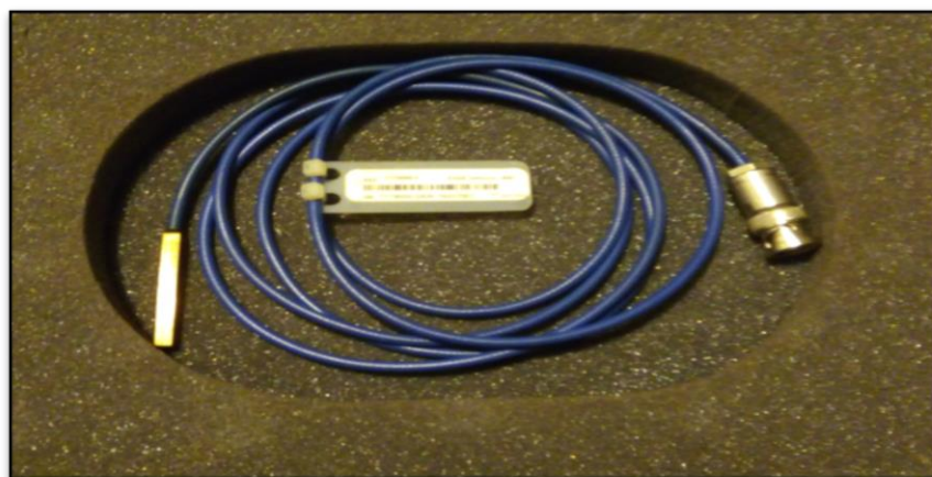
Figure (IV.7) : Diode Sun Nuclear EDGE utilisée dans les mesures des profils et des rendements [Centre Anti Cancer CHU de Constantine]
