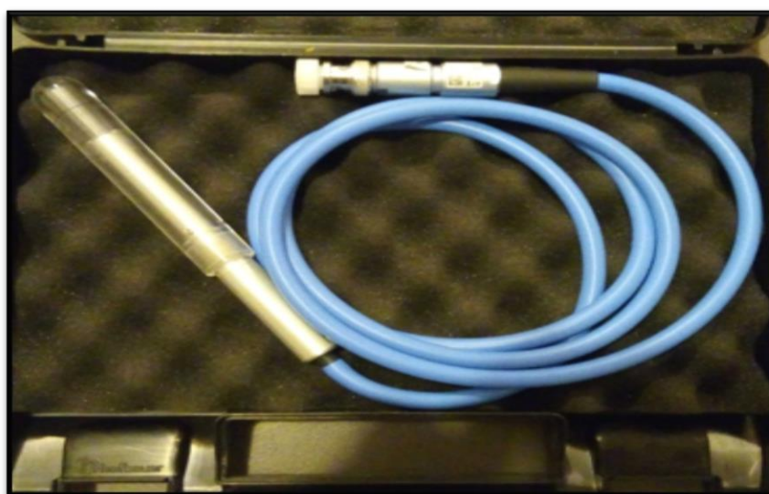
Figure (IV.5) : Une chambre d'ionisation cylindrique PTW type Farmer 0.6 cm 3 [Centre Anti Cancer CHU de Constantine]
