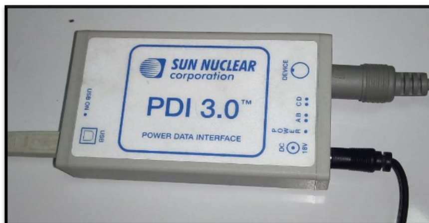
Figure (IV.8) : Electromètre « SNC-Electromètre» (power data interface 3.0) [Centre Anti Cancer CHU de Constantine]
