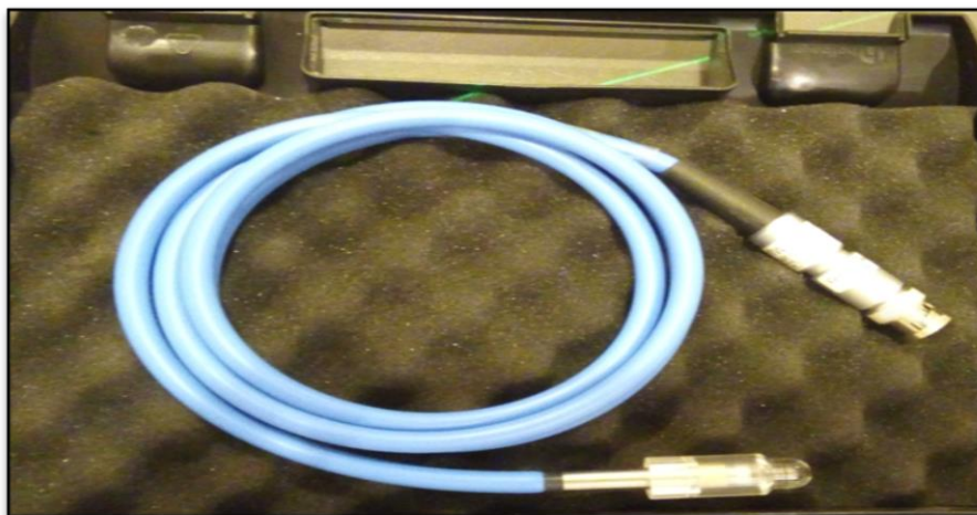
Figure (IV.6) : Une chambre d'ionisation cylindrique PTW type Pin Point 0.015\text{cm}^3 [Centre Anti Cancer CHU de Constantine]
