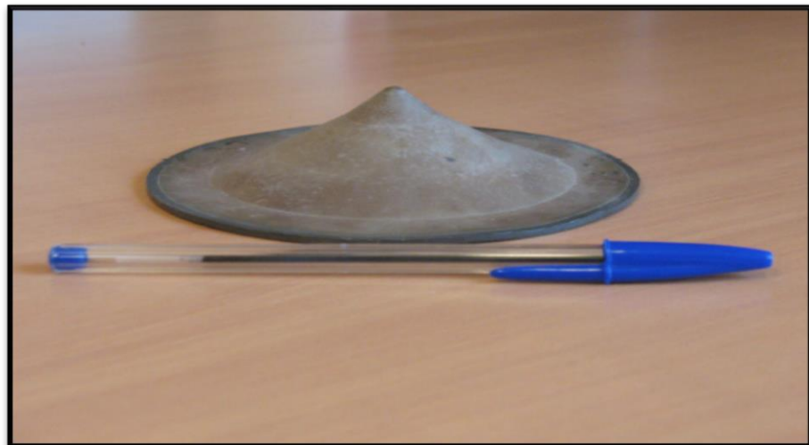
Figure (I. 11) : Photographie du cône égalisateur d'un accélérateur pour un faisceau de photons [25]
