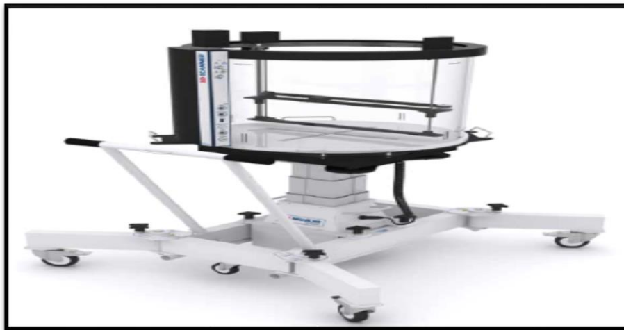
Figure (IV.3) : Fantôme d'eau automatique « 3D SCANNER » [Centre Anti Cancer CHU de Constantine]
