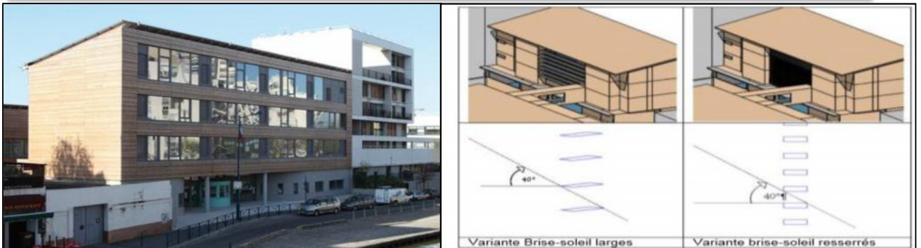
Figure 30: Le travail sur l'optimisation des brise-soleils
