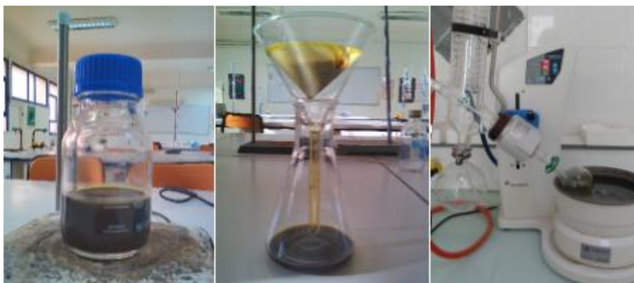
Figure 22 : les étapes de l'extraction (macération, filtration, évaporation à sec)
