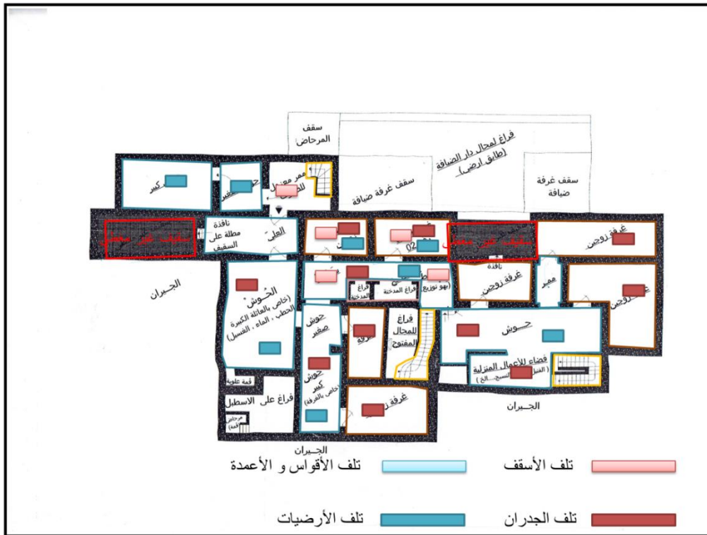
الشكل رقم 56: مخطط للطابق الأول بمنزل الطالب صوالح
