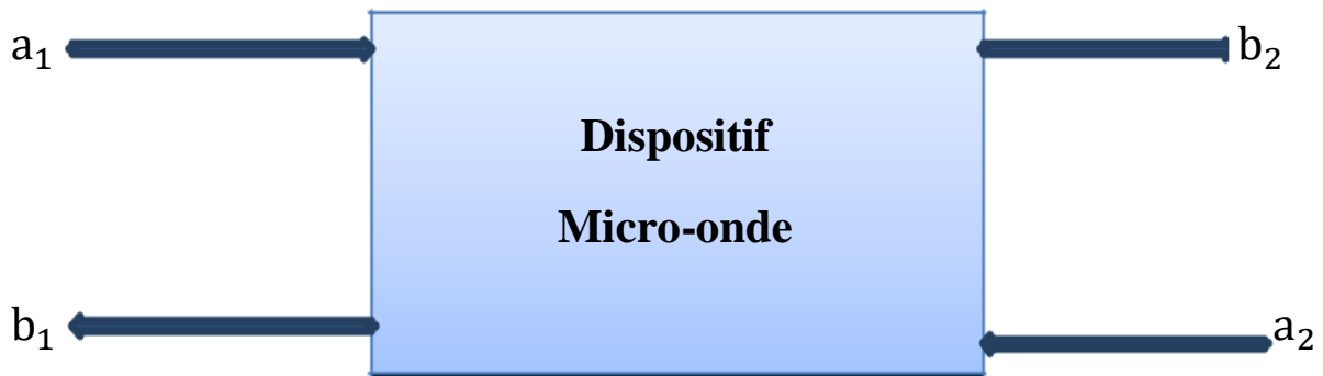
Figure I. 4: Signaux aux bornes d'un dispositif micro-onde.
