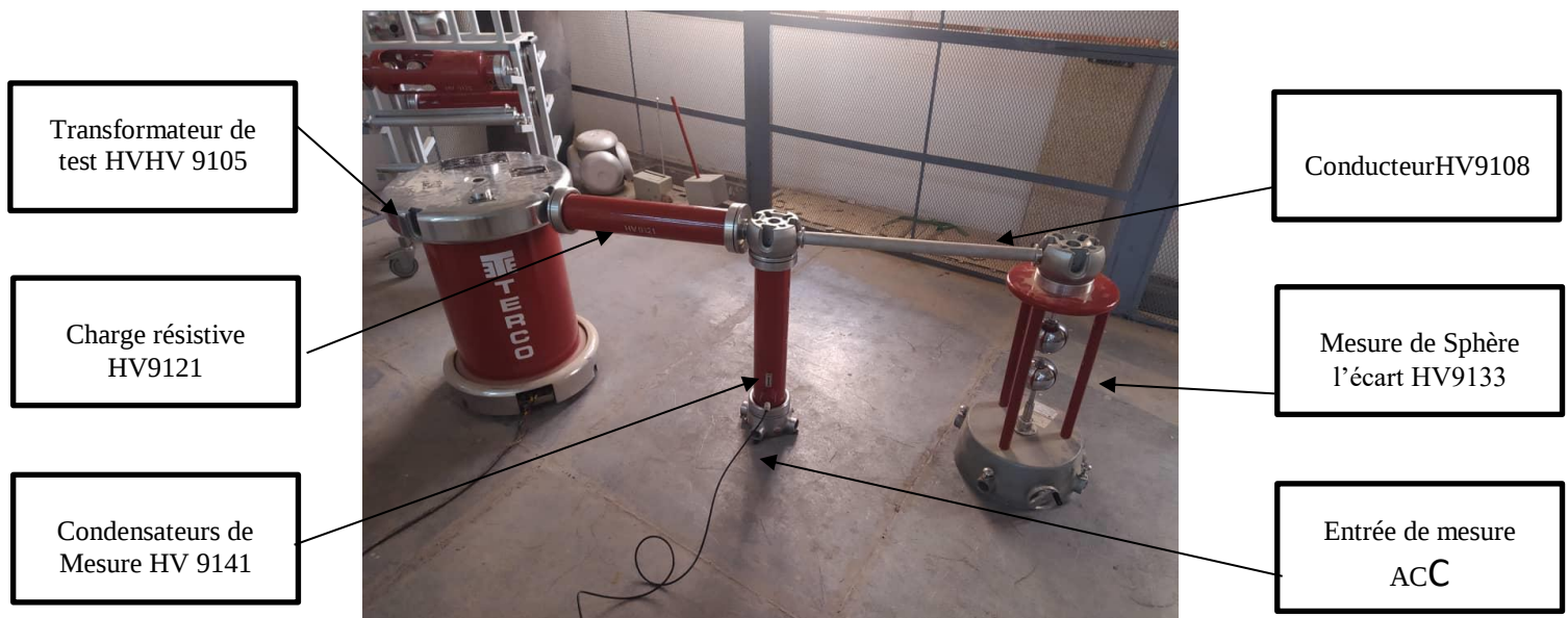
Figure III.03 : Configuration de mesure Tension de Claquage
