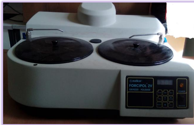
Figure II.2 : Photo de polissage mécanique avec un polisseur à disque (FORCIPOL 2V).
