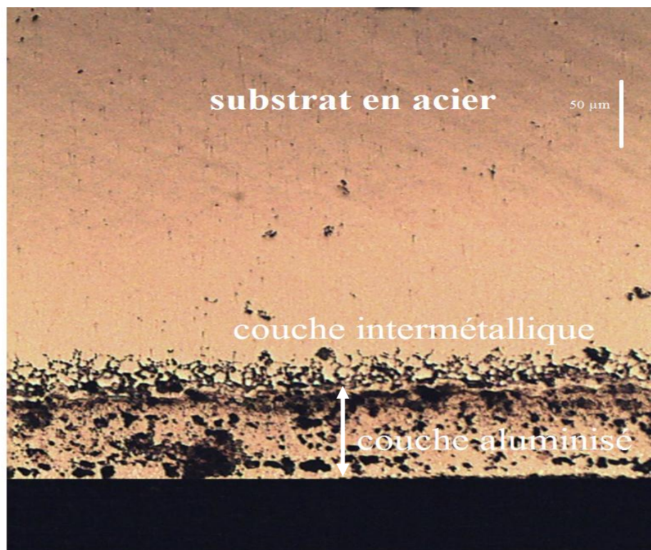
Figure 3-1 : image de microscope optique d'un échantillon aluminisé à 900 °C pendant 4 h
