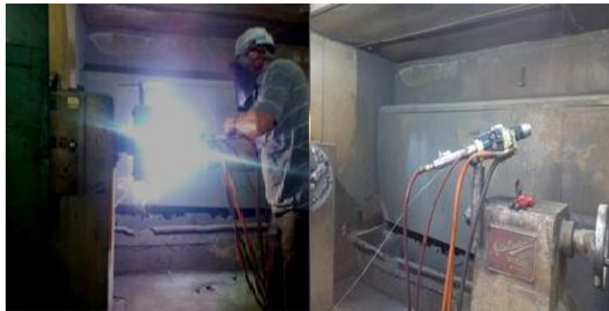
FigureII.3 : Pistolet de projection à arc électrique « Arc spray 234 ».
