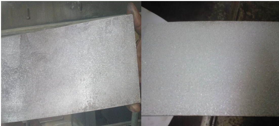
Figure II .2 : Plaque d'acier grenaillée avec des grains de fonte (à gauche) et une plaque traitée par l'aluminium (à droite).
