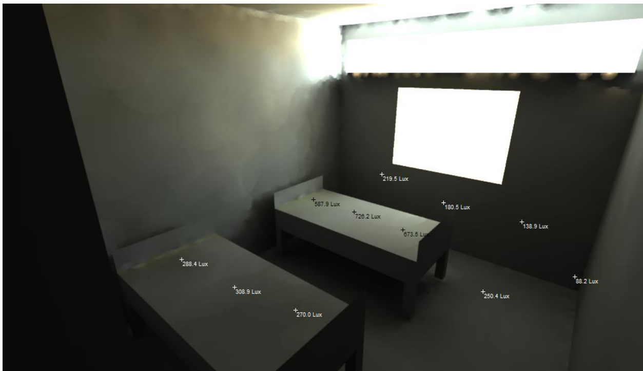
Figure 219 : Niveau d'éclairage intérieur. Auteurs
