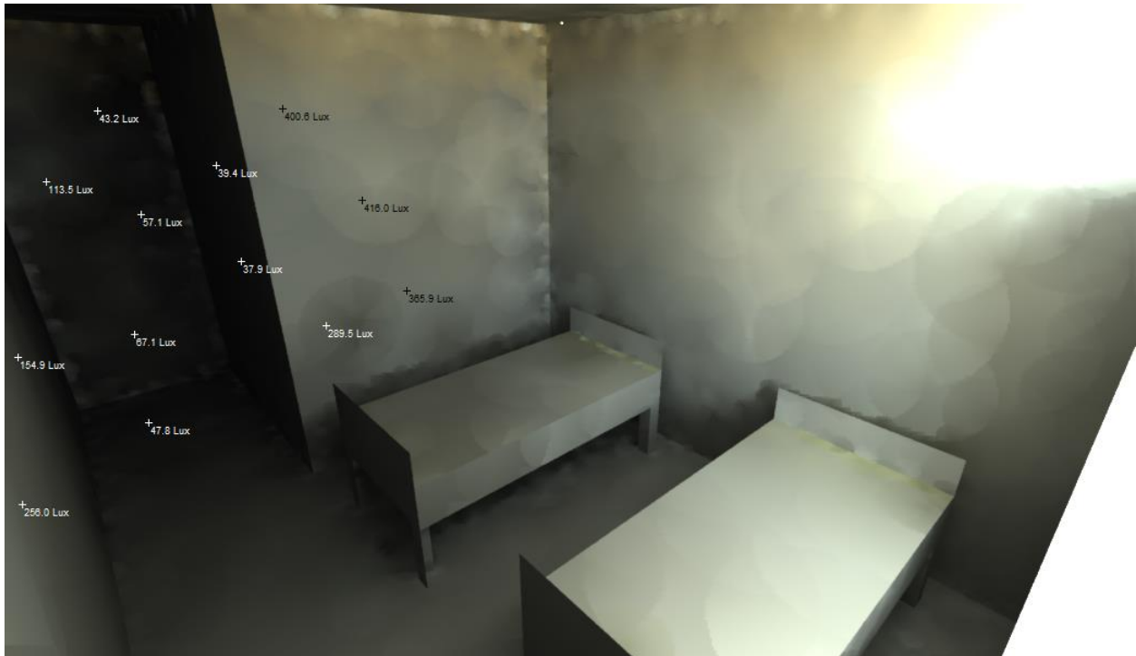
Figure 220 : Niveau d'éclairage intérieur. Auteur
