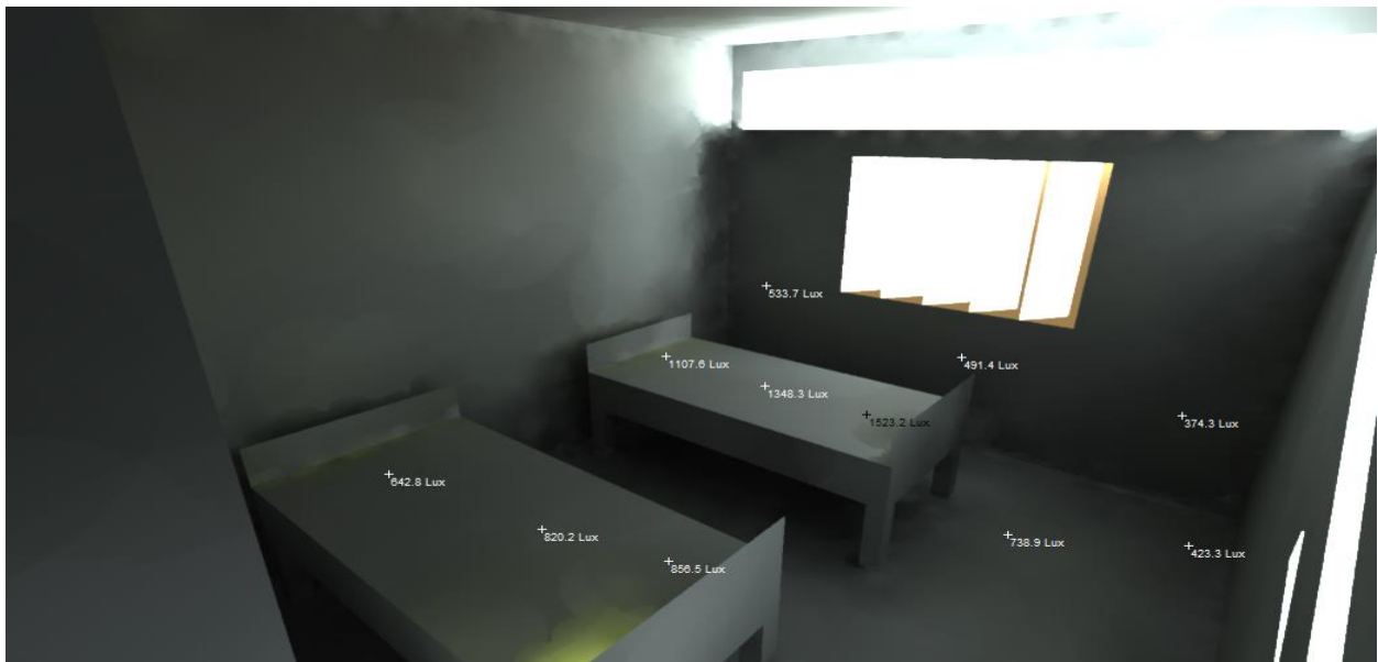
Figure 217 : Niveau d'éclairement intérieur. Auteur
