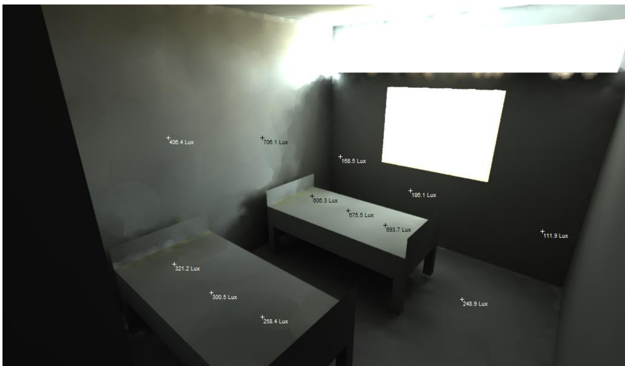
Figure 215: Niveau d'éclairement intérieur. Auteur
