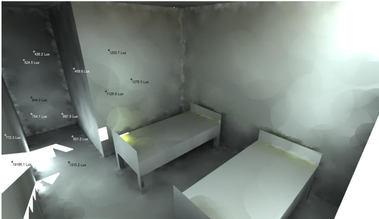
Figure 218: Niveau d'éclairage intérieur. Auteurs
