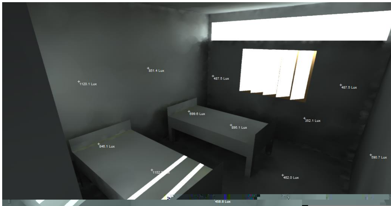
Figure 213 : Niveau d'éclairage intérieur. Auteur
