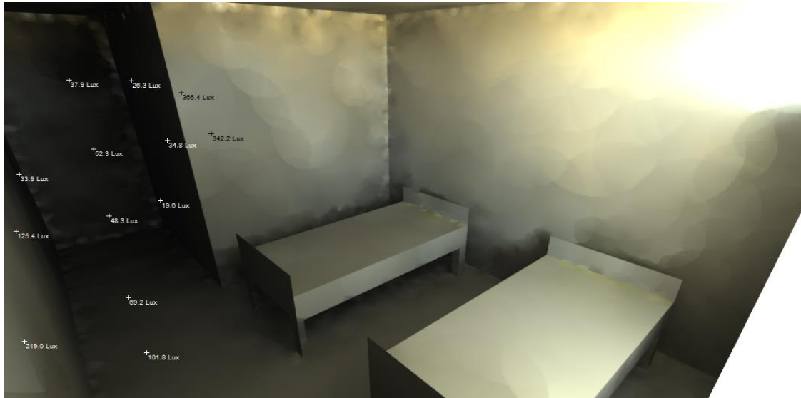
Figure 224 : Niveau d'éclairage intérieur. Auteur
