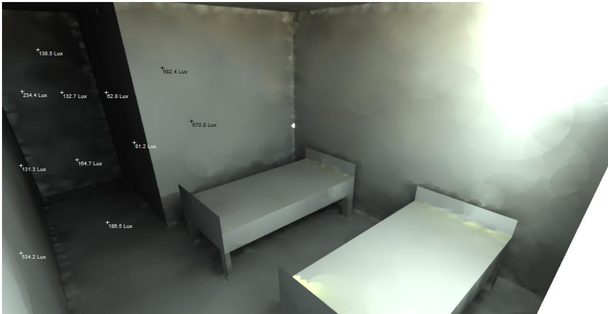
Figure 222 : Niveau d'éclairage intérieur. Auteur
