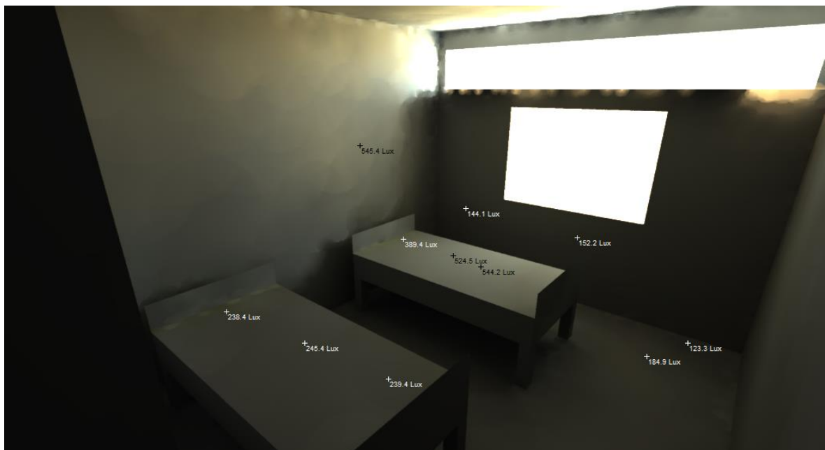
Figure 223 : Niveau d'éclairage intérieur. Auteur
