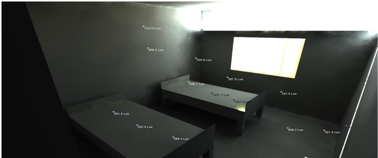
Figure 221 : Niveau d'éclairage intérieur. Auteur
