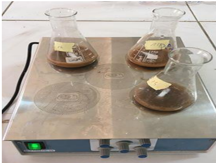
Figure 11. Agitateur de laboratoire.
