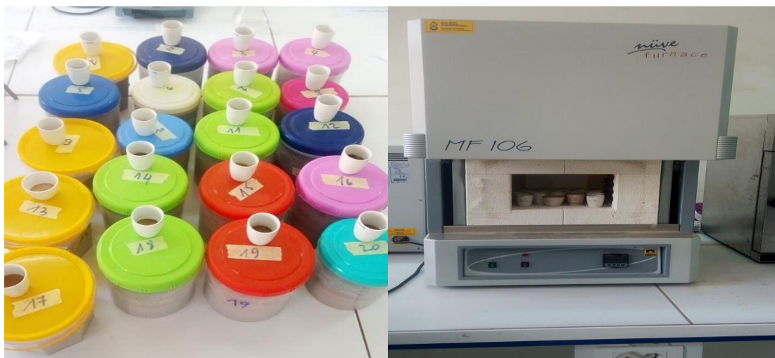
Figure 13. Séchage de 10 g du sol dans le four à moufle pendant (24h) à 105 °C.
