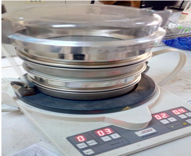
Figure 15. Tamisage du sol.
