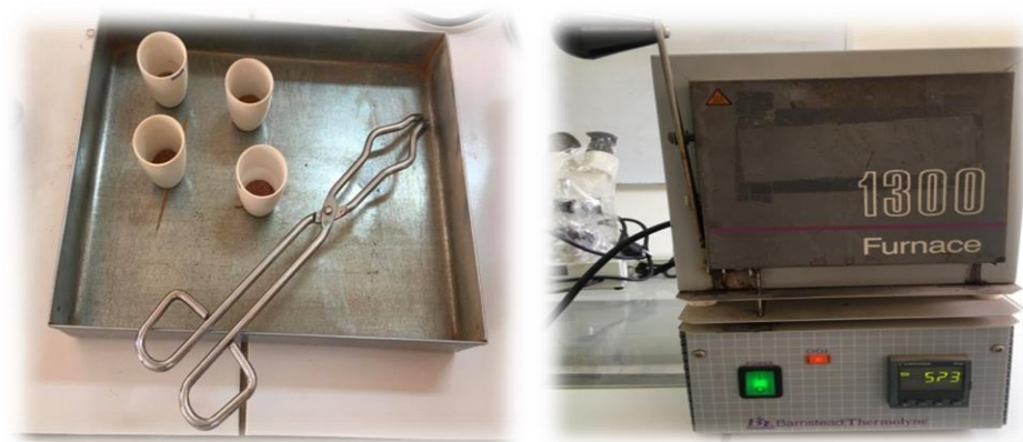
Figure 17. Calciner le sol au four à moufle à 550 °C pendant 06 heures.
