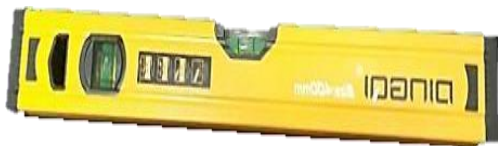
Fig. III.8 : Le niveau à bulle. Source : Auteur
