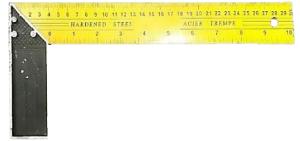
Fig. III.7 : L'équerre de menuisier. Source : Auteur
