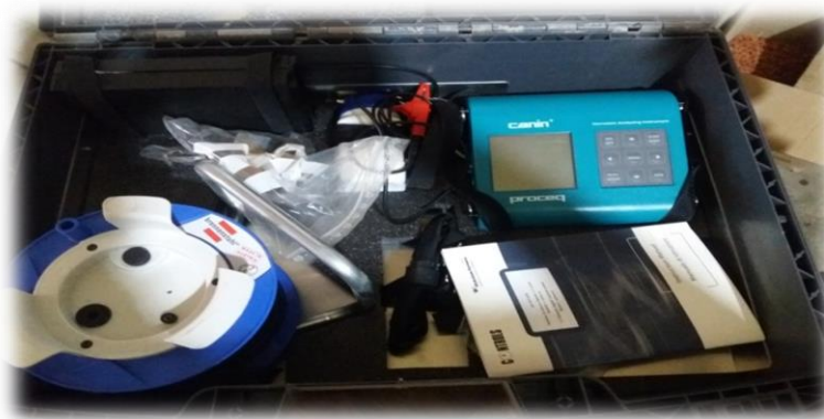
Figure II-18 : Appareil de mesure de corrosion canin + de notre laboratoire
