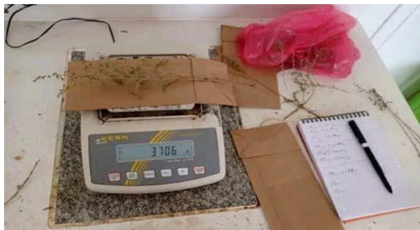
Figure N°12 : Mesure de teneur en eau (%) (Cliché originale,2023).
