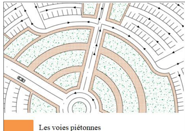
Figure 36 les voies piétonnes dans le parking sous-sol, source fait par l'auteur
