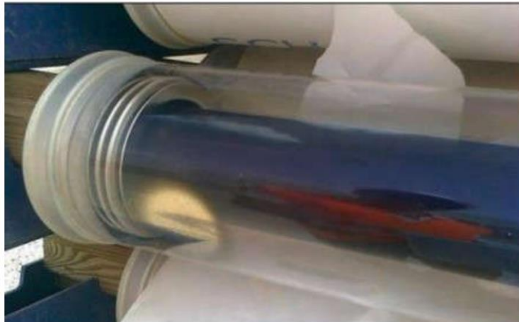
Figure III. 17 : Tube récepteur de la centrale [16]
