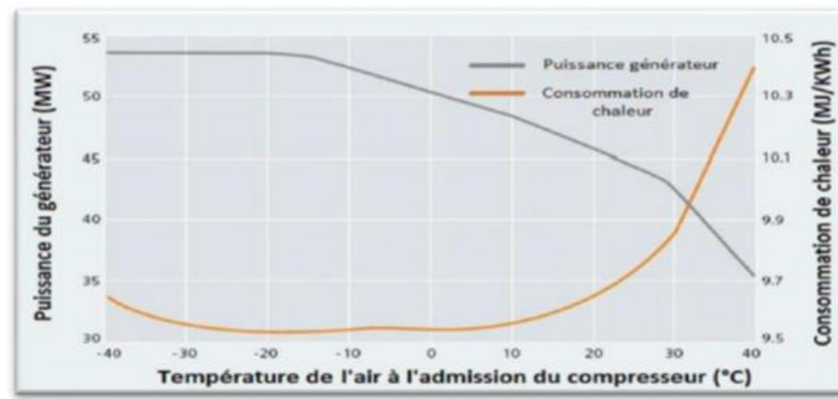
Figure III. 25 : Puissance du générateur et consommation en fonction de la température d'admission de la SGT-800 [18]
