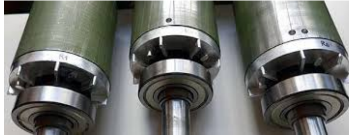
Figure 1.6: Rotors d'une MAS cage d'écureuil avec et sans défaut
