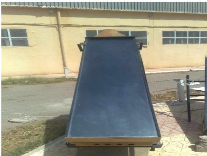
Figure V-4: capture solaire d'air
