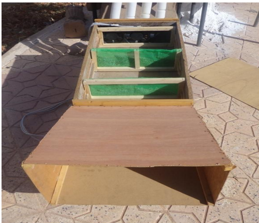
Figure V- 10: boîte de dessiccation avec deux tiroirs de gel- silica.
