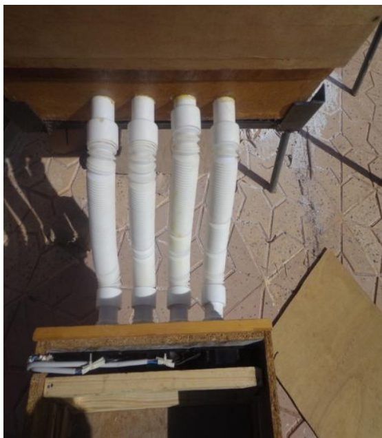
Figure V -7: Quatre tuyères pour l'admission de l'air.
