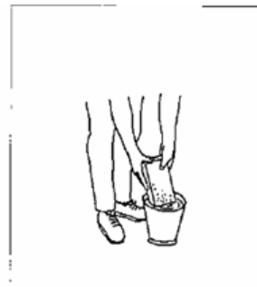
Fig. 35 : Prétrempar les blocs stabilisés.
