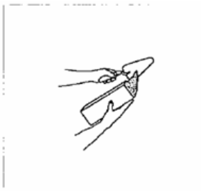
Fig. 36 : Bien tartiner les faces à jointoyer.
