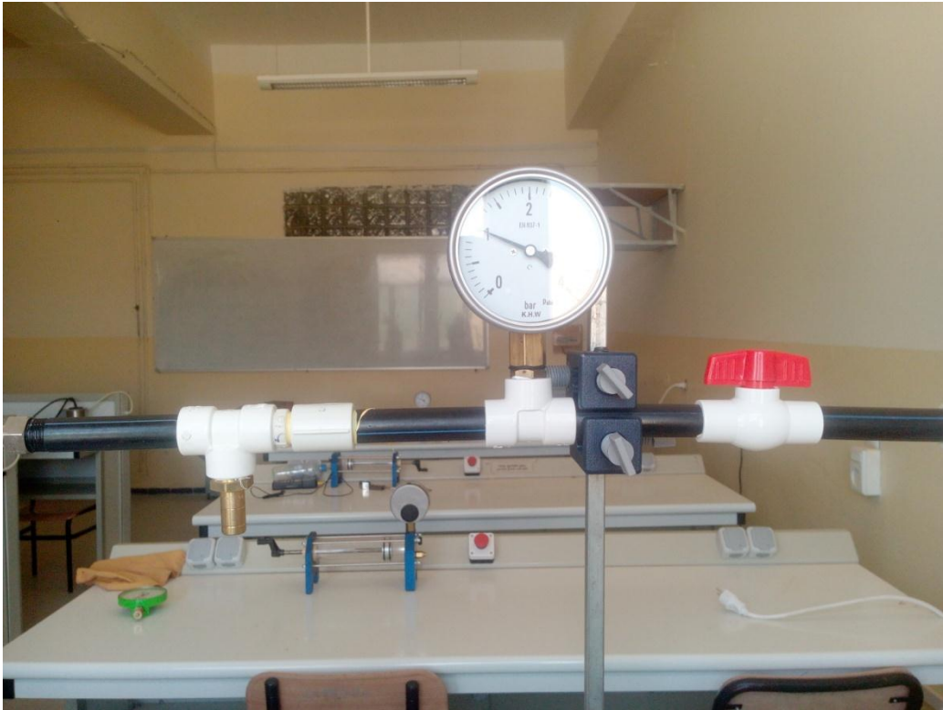
Fig. IV. 4. Type de manomètre utilisé pour mesurer les pression en bar.
