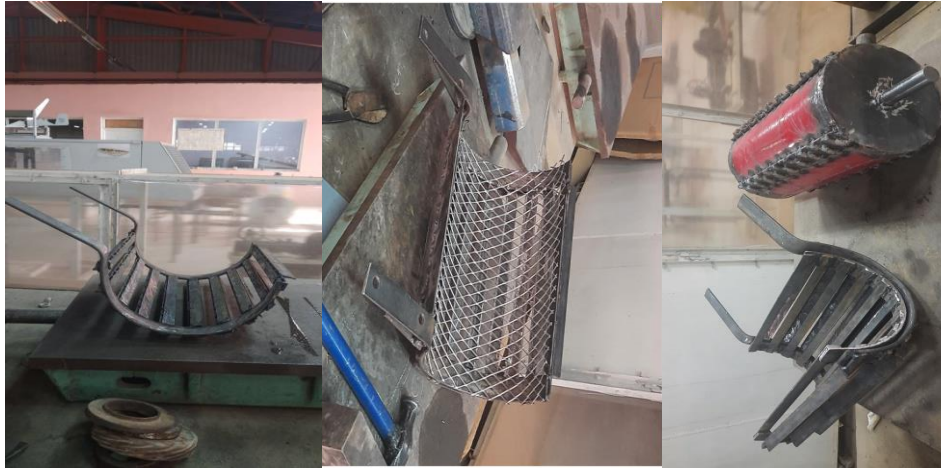
Fig. III. 6 : Photos du contre batteur.
