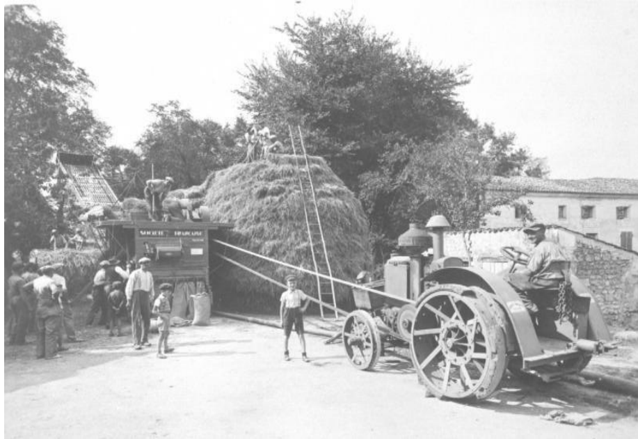
Fig. I.12: Tracteur relié à la batteuse avec une longue courroie.
