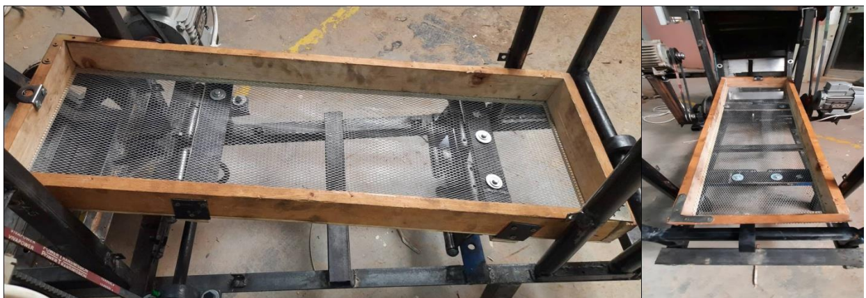
Fig. III. 9 : Photos du tamis.
