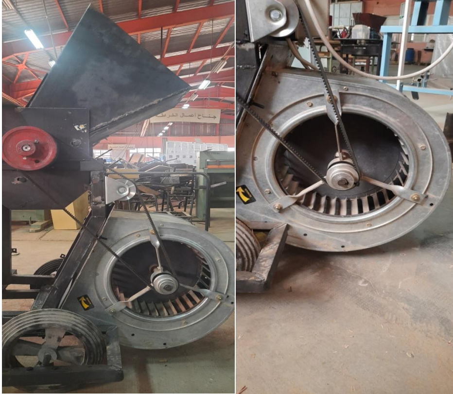
Fig. III. 12 : le ventilateur utilisé et son emplacement
