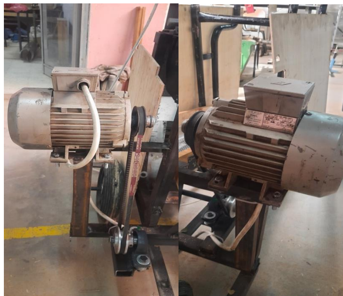
Fig. III. 11 : Photos du deuxième moteur et de son support.
