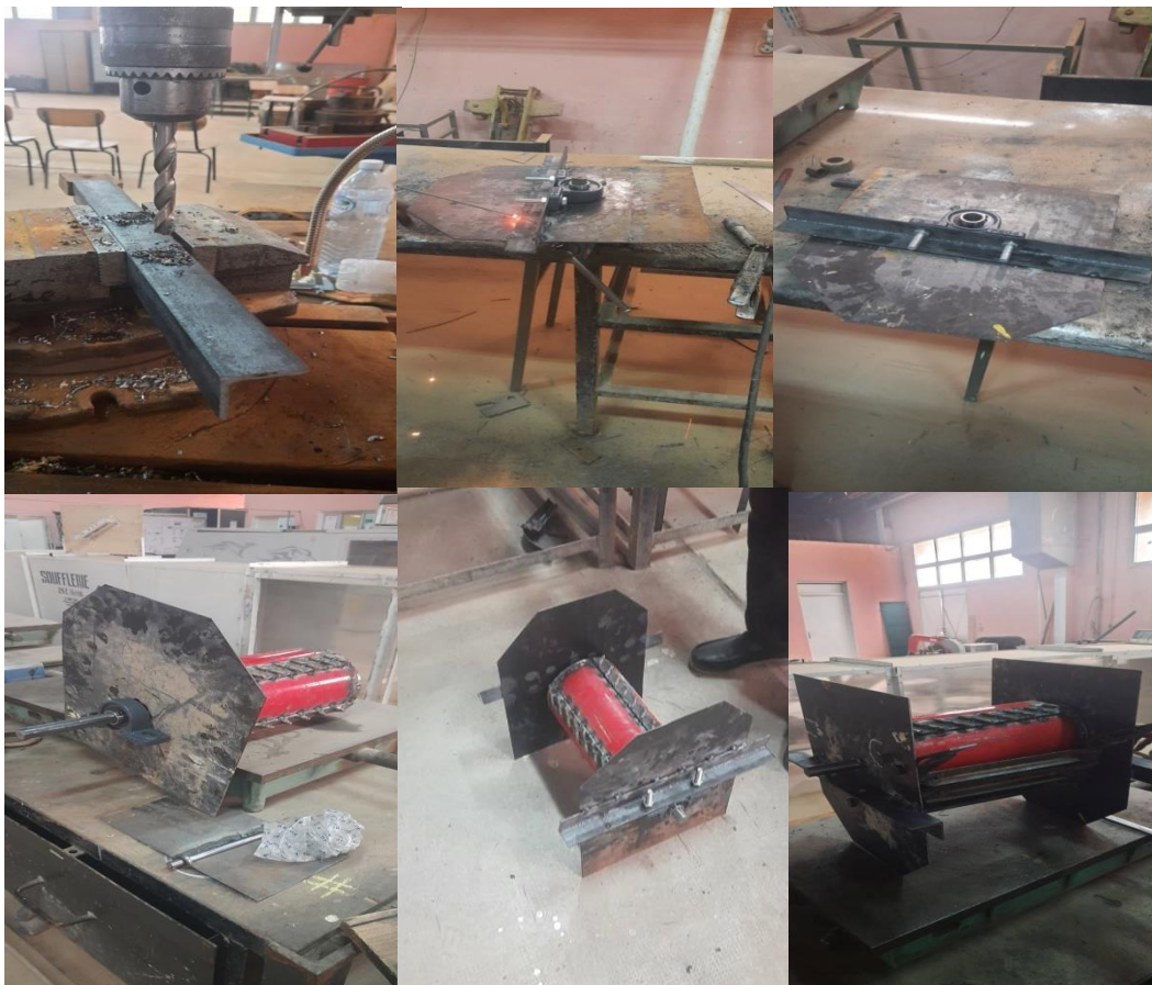
Fig. III. 5 : Photos des étapes de réalisation du support de tambour.
