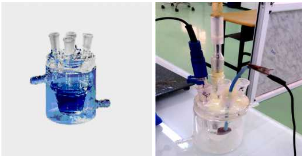
Figure II.3 : La cellule électrochimique en verre pyrex a trois électrodes
