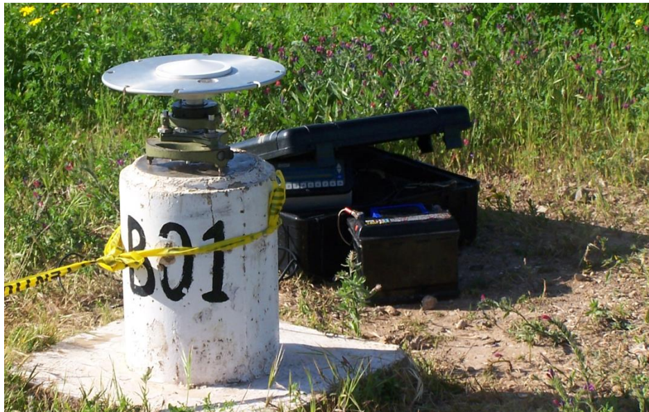
Figure III.21 : Borne avec antenne Ashtech Z-XII3
