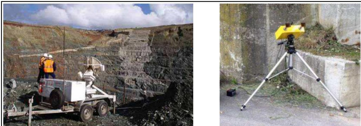
Figure I.3 : Exemple de radars interférométriques
