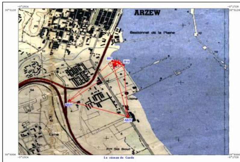
Figure IV.26 : Réseau de garde
